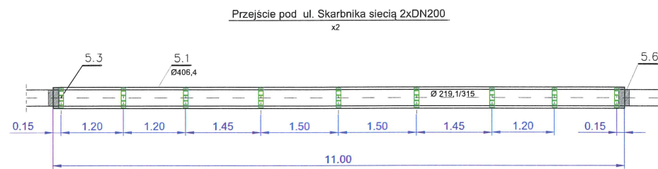
SCHEMAT ROZMIESZCZENIA PŁÓZ W RURACH OCHRONNYCH I PRZECISKOWYCH
